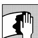
Curatarea suprafetei: indepartati orice contaminare inaintea aplicării Autosurfacer WB folosind degresantii existenti . Daca după slefuire au ieșit pete de chit, evitați contactul cu apa (ex. Degresantul pe baza de apa)
